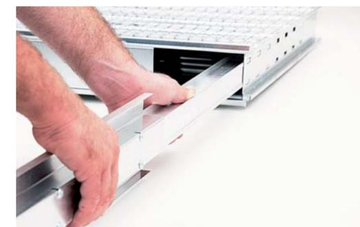
Posizionare il montante laterale 3 nella apposita asola del binario superiore e bloccare;
